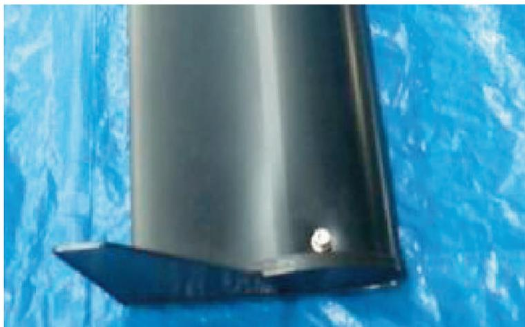
Svitare la vite che tiene fissato il Winglet plastico alla pala
