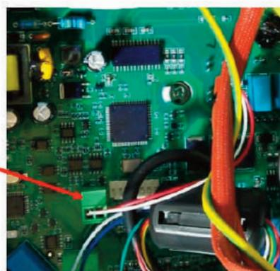
Disinserire i faston sull' elettronica delle fasi motore e sonda
