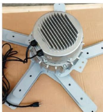
Per poter montare la staffa è necessario ruotare il motore poggiandolo sulla stella. Posizionare la staffa sopra il motore in modo da centrare i fori sulla piastra anticaduta.
