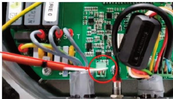
Inserire il connettore verde, con fili Bianco/Rosso, del sensore di temperatura del motore nell'apposito connettore sull'elettronica (posizionato come in figura).
