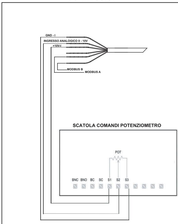
**NOTA: È necessario portare in un quadro ad altezza uomo, i cavi A e B per il collegamento in Modbus per azioni di manutenzione e diagnostica**
