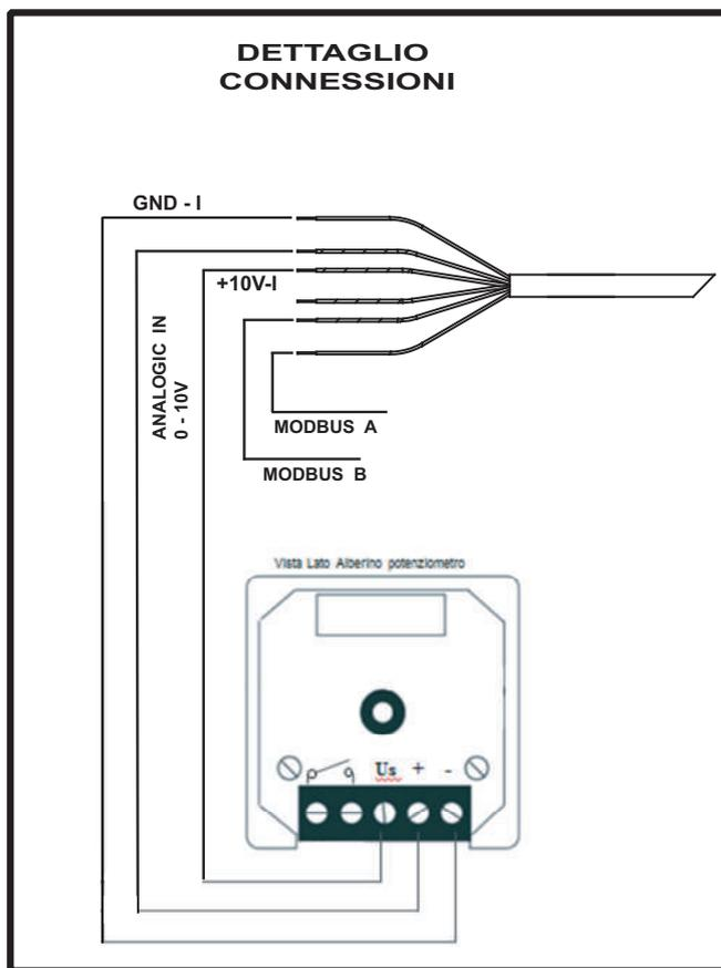
**NOTA:** È necessario portare in un quadro ad altezza uomo, i cavi A e B per il collegamento in Modbus per azioni di manutenzione e diagnostica
